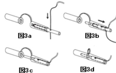
図 3 ピン・アダプタの取り付け方法
