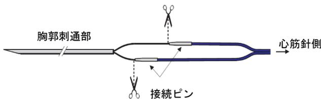
図 2 ワイヤーを接続ピンの端で切断
